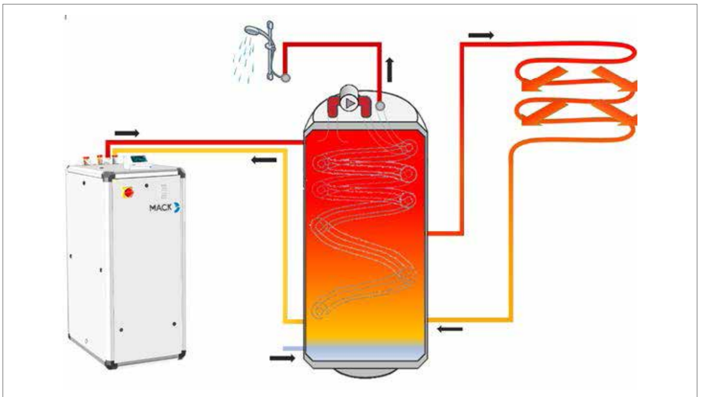
Das Schema zeigt eine SWWP mit einem Multifunktionsspeicher und einer Flächenheizung
